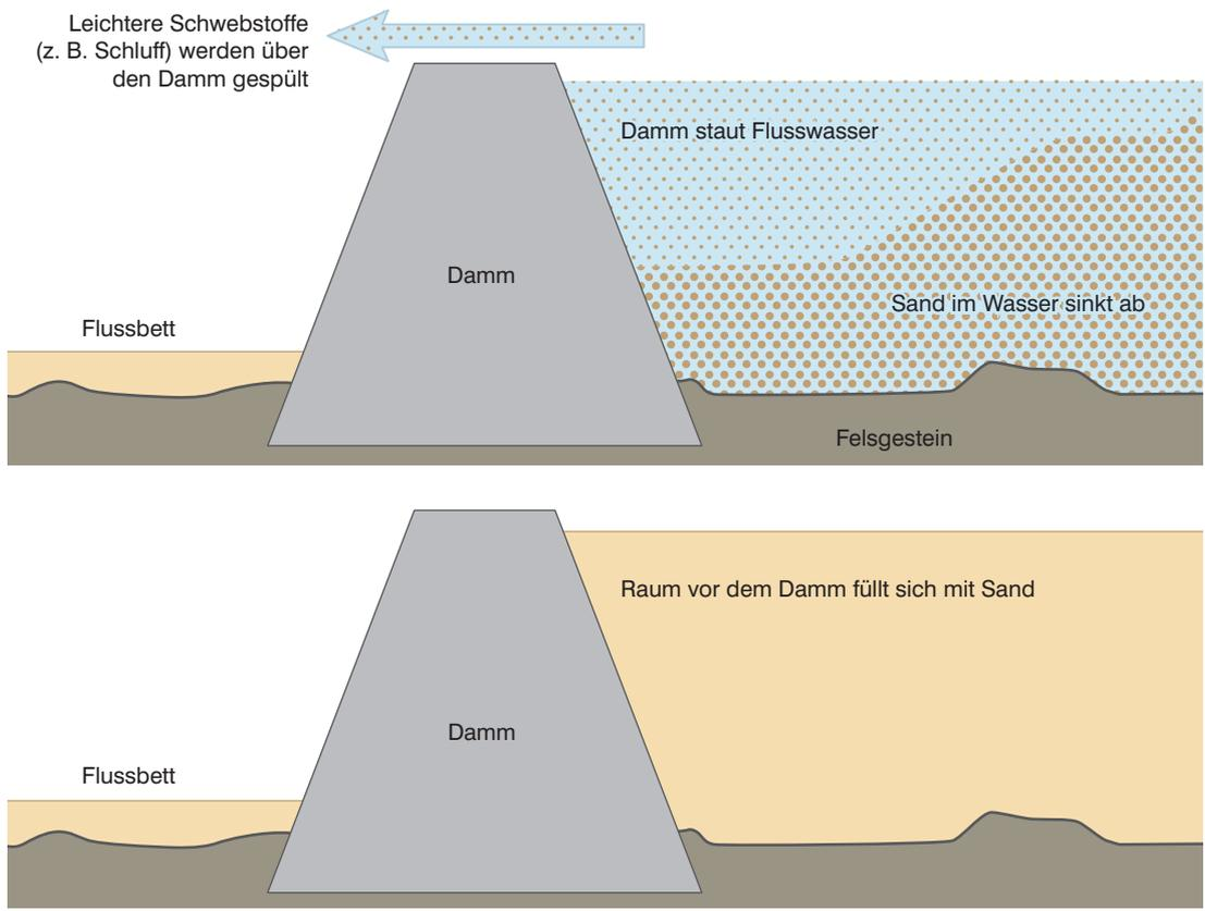
**Bild 4: Funktionsweise von Sanddämmen**
